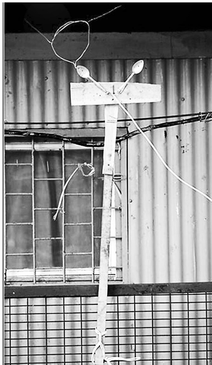
Антенна из алюминиевых ложек и петли
